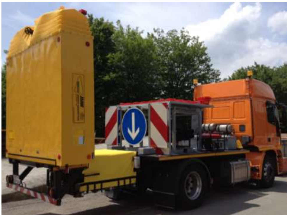
panneau de signalisation en 2 parties avec flèche croisée (lumineuse) en haut et signaux (moteur électrique) en bas
