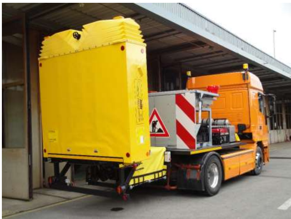
panneau de signalisation et coussin amortiseur en position de transport
