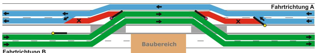
Bild 4: Wechselverkehrsführung - Phase 2
