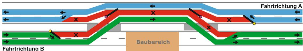
Bild 3: Wechselverkehrsführung - Zwischenphase für Richtungswechsel
